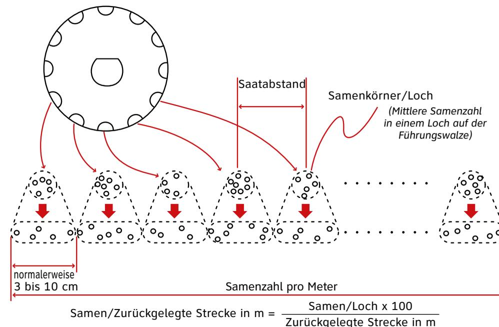
**Bitte beachten:** der Saatabstand ist von der Kombination der Zahnradzähne (11 Einstellungen) und der Lochzahl auf der Dosierrolle abhängig. Das Führungsrad kann je nach Bodengüte und Fahrgeschwindigkeit rutschen. Deshalb ist die angegebene Samenzahl nur ein Durchschnittswert. Wenn das Führungsrad rutscht, sind die Saatabstände größer und die Sämenge geringer. Vergewissern Sie sich deshalb, dass das Rad nicht rutscht.
