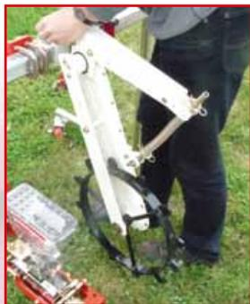
**5** Deslizar el eje hexagonal en la muesca del soporte de la rueda así como en las tolvas de fertilizador.
