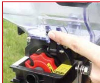
**2** Fijar el sistema de sujeción en la parte de la sembradora prevista a este efecto.
