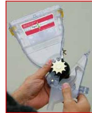
**4** Para sacar el pasador, gírelo como se indica en la imagen que aparece a continuación y tire para extraer el eje y el rodillo.
