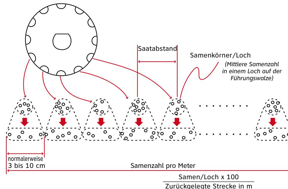
**Bitte beachten:** der Saatabstand ist von der Kombination der Zahnradzähne (11 Einstellungen) und der Lochzahl auf der Dosierrolle abhängig. Das Führungsrads kann je nach Bodengüte und Fahrgeschwindigkeit rutschen. Deshalb ist die angegebene Samenzahl nur ein Durchschnittswert. Wenn das Führungsrads rutscht, sind die Saatabstände größer und die Sämenge geringer. Vergewissern Sie sich deshalb, dass das Rad nicht rutscht.
