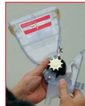
**4** Para sacar el pasador, gírelo como se indica en la imagen que aparece a continuación y tire para extraer el eje y el rodillo.
